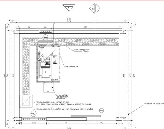
PLANTA BAIXA - ESTAÇÃO ELEVATÓRIA DE ESGOTO
